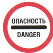
Опасность (запрещается дальнейшее движение в связи с дорожно-транспортным происшествием, аварией или другой опасностью)
